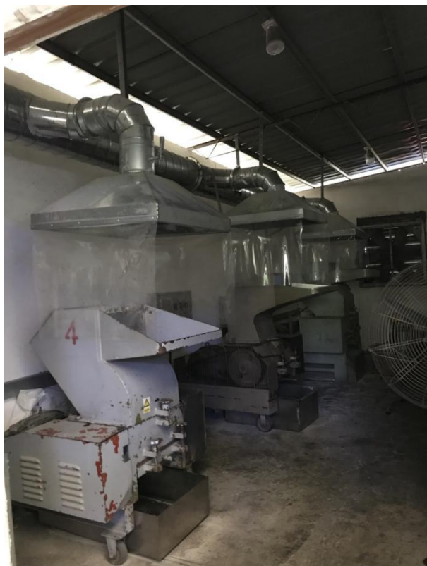
破碎废气收集措施（C1车间）
